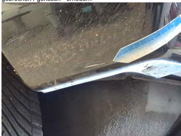
Beschädigung 5: Stossfänger hinten: Stossfänger hinten links - verkratzt / verschürft - Smart Repair
