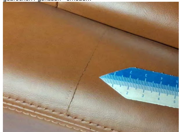
Beschädigung 2: Sitz hinten: Sitzpolster 2. Reihe (links) - gebrochen / gerissen - Smart Repair
