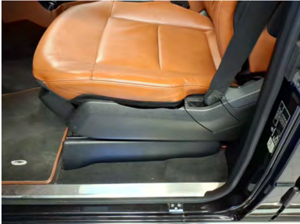
Beschädigung 1: Sitz vorn: Sitzkastenverkleidung links - gebrochen / gerissen - erneuern
