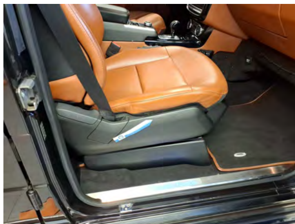
Beschädigung 4: Sitz vorn: Sitzkastenverkleidung rechts - gebrochen / gerissen - erneuern
